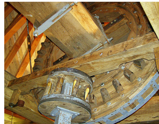
Mécanisme avec le rouet (la grande roue) fixé sur l'arbre horizontal, porte ailes, qui entraîne la lanterne et l'arbre vertical où est fixé la meule.
