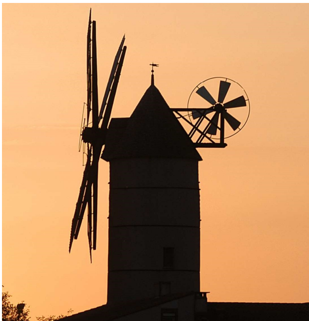
Moulin de l'Épinay à La Chapelle-Saint-Florent, avec son moulinet pour son orientation automatique face au vent.
